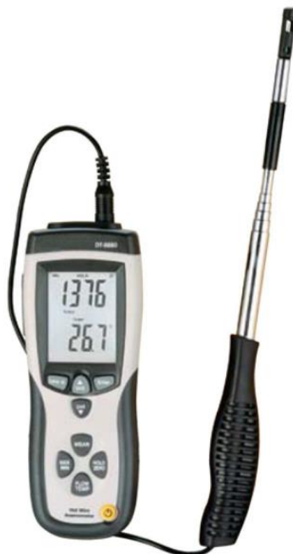
Rys. Termoneometr. Rodzaj przyrządu pomiarowego, który służy do pomiaru prędkości przepływu powietrza. Nagrzewany prądem czujnik jest chłodzony określonym strumieniem powietrza, co powoduje zmianę proporcji natężenia prądu oraz oporności włókna.
