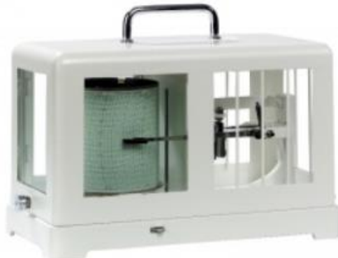
Rys. Termograf - przyrząd mierzący temperaturę i rejestrujący jej przebieg w funkcji czasu.
