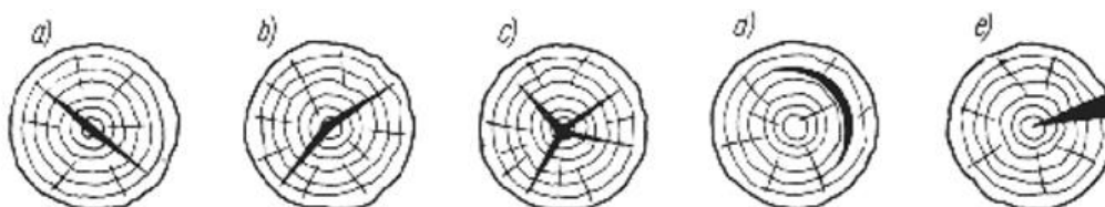
Rys. 8. Pęknięcia czołowe drewna okrągłego: a) rdzeniowe proste, b) rdzeniowe załamane, c) rdzeniowe gwieżdźdźiste, d) okrężne, e) z przesychania.
