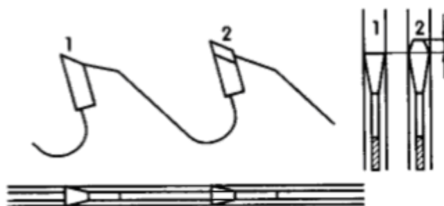
Rys. 10. Uzębienie grupowe: 1 – ząb strugający, 2 – ząb nacinający.
